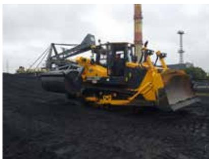
Недавно на один из важных энергетических объектов в Польше были поставлены изделия TD-15M второй серии. Это первые из наших новых моделей, которые были оснащены навесным оборудованием для работы на наклонных поверхностях, что помогает безопасной работе установки при уплотнении угольных отвалов.
